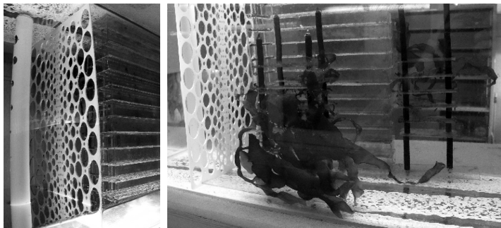
Рис. 5 (слева). Экспериментальные пластины с растущей ламинарией Рис. 4. Пластина и труба с отверстиями, выравнивающие гидродинамические потоки по вертикали и горизонтали
