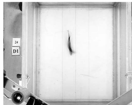
Рис. 7. Установка для изучения асимметрии реакции избегания рыб при электрической стимуляции Частота синусоидальных электрических колебаний 50 Гц, уровень воды - 12 см, электропроводность 33-38 мСм/м
