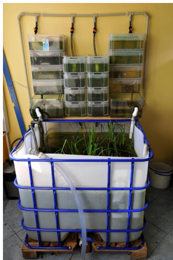
Рис. 3. Экспериментальная модель акваустановки для выращивания личинок D. latissimus
