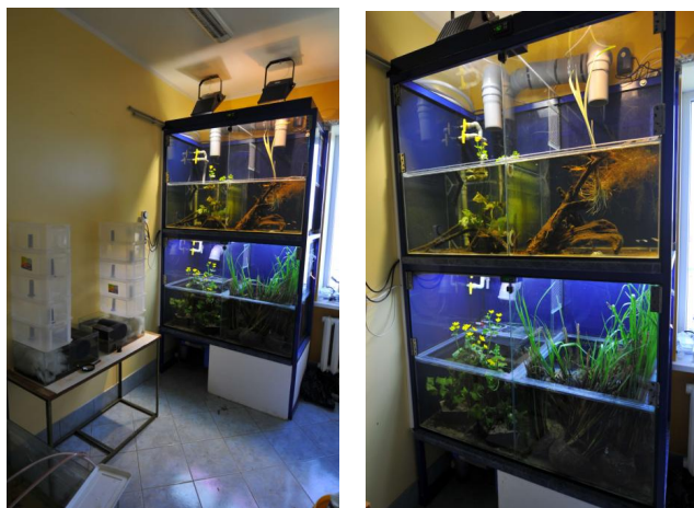
Рис. 1. Общий вид аквариумной установки с замкнутым водообеспечением для содержания D. latissimus (в весенне-летнем режиме работы)
